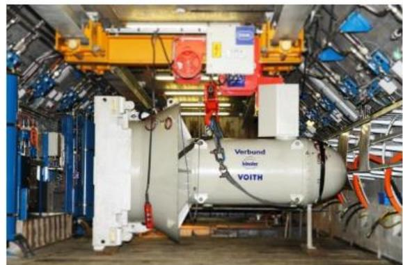
Ilustración 28 - Turbinas Stream Diver – Esquema teórico y real
