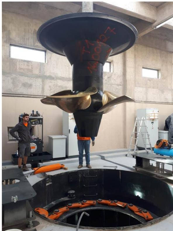
Ilustración 24 - Turbina Kaplan eje vertical del aprovechamiento de estudio
