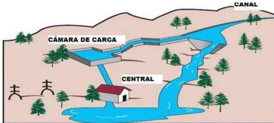
Ilustración 13: Esquema básico de una central de agua fluyente
